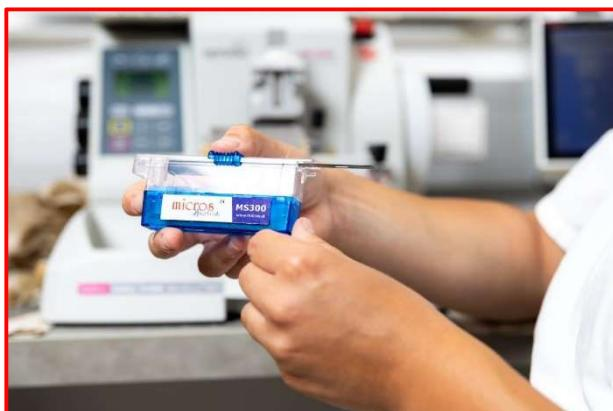
2. En faisant très attention, introduire le dispositif dans le porte-lame du microtome, toujours à l'aide du levier prévu à cet effet, afin de rendre plus facile la manœuvre d'introduction. Si le distributeur n'expulse pas la lame, ne pas la force
