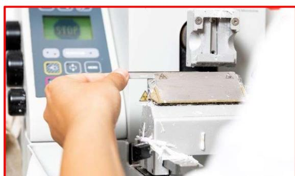
3. Sobald das erwartete Ende der Lebensdauer der Mikrotomklinge erreicht ist, wird Sie auf der Unterseite in den Spender zurück hineingeschoben.
