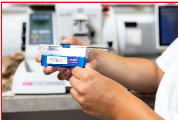
2. Con estrema cautela, inserire il dispositivo nel portalama del microtomo, utilizzando sempre l'apposita leva, al fine di agevolare la manovra di inserimento. Se il dispender non espelle la lama, non forzare la fuoriuscita della lama.
