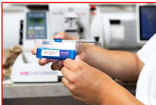
2. Con extrema precaución, introduzca el dispositivo en el porta cuchillas del microtomo, utilizando siempre la palanca correspondiente, para facilitar la maniobra de inserción.
